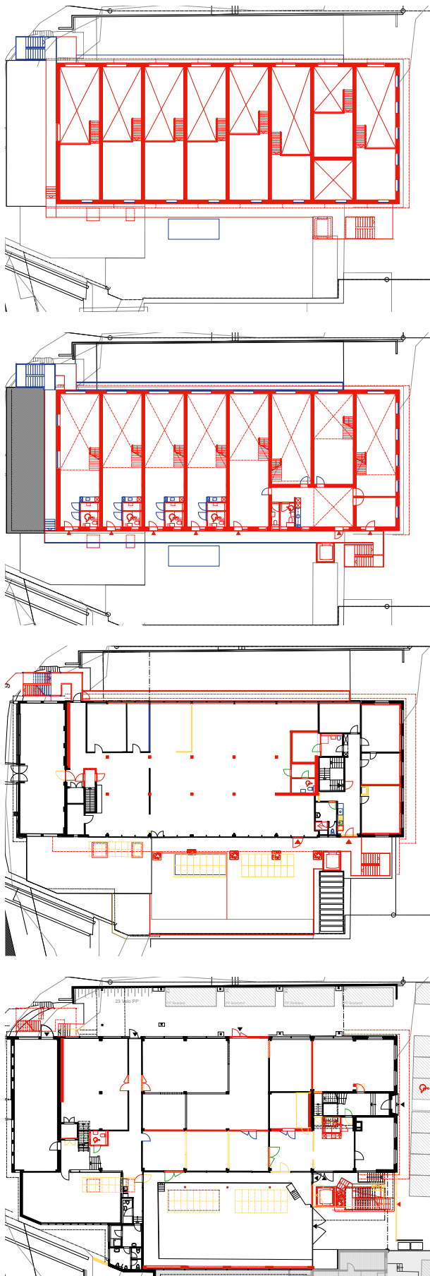
Vom Erdgeschoss nach oben nimmt der Aufwand zur Erneuerung des Werkhofs zu . Grundrisse, Mst. 1:750.
