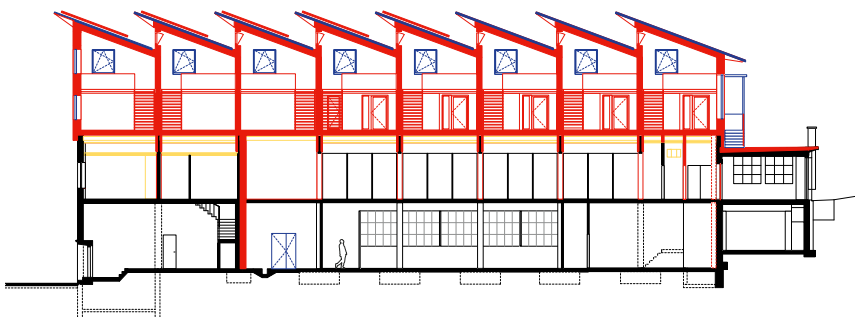
Erneuerung, Umbau und Aufstockung des Werkhof 29. Aufriss, Mst. 1:500.
